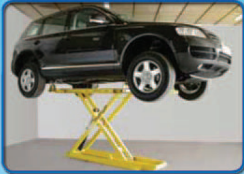
RISING BY RUBBER PADS AND WHEELS FREE SOULEVEMENT AVEC TAMPONS ET ROUES LIBRES HEBEN MIT GUMMIAUFLAGEN FÜR FREIE RÄDER
