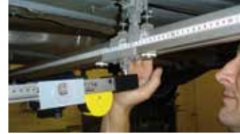
Möglicher Anschluss an Messteleskop für Diagonal und Längenmessung
