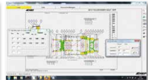
Einstellung des Datenblattes nach Punkt zu Punkt Längenangaben (Gitternetz) oder auch kumuliert mit variablem Startpunkt und Anpassung der Höhenmasse an verwendetes Messsystem.
