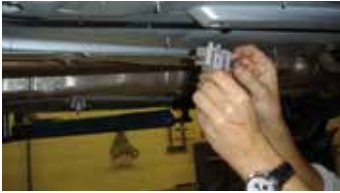
Befestigen der Uniadapter an symmetrischen Löchern am Unterboden
