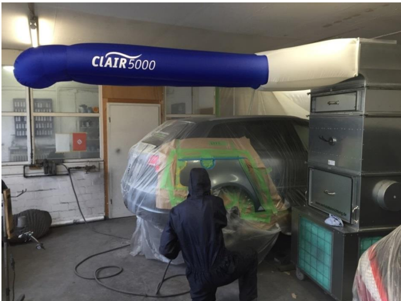
für niedrige Räume mit kurzem Filterkanal (Mindestraumhöhe 2,65 m) Gerät nur 2,43 m anstatt 2,65 m hoch
